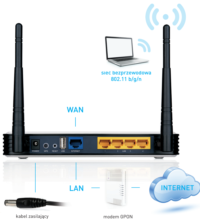
Rysunek 1. Schemat podłączenia routera do modemu optycznego GPON
