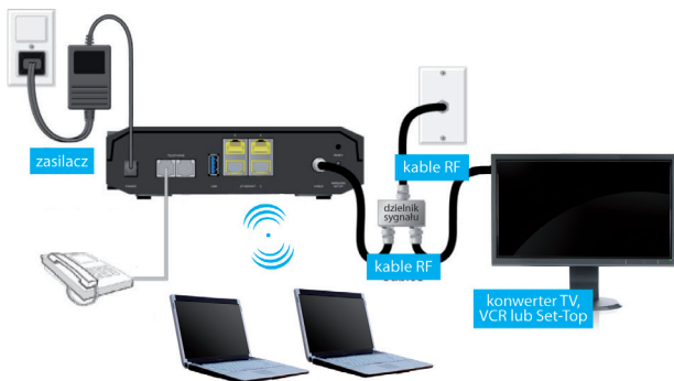
Rysunek 5 Schemat połączenia komputera do modemu Cisco EPC3928 przy użyciu sieci bezprzewodowej WiFi
