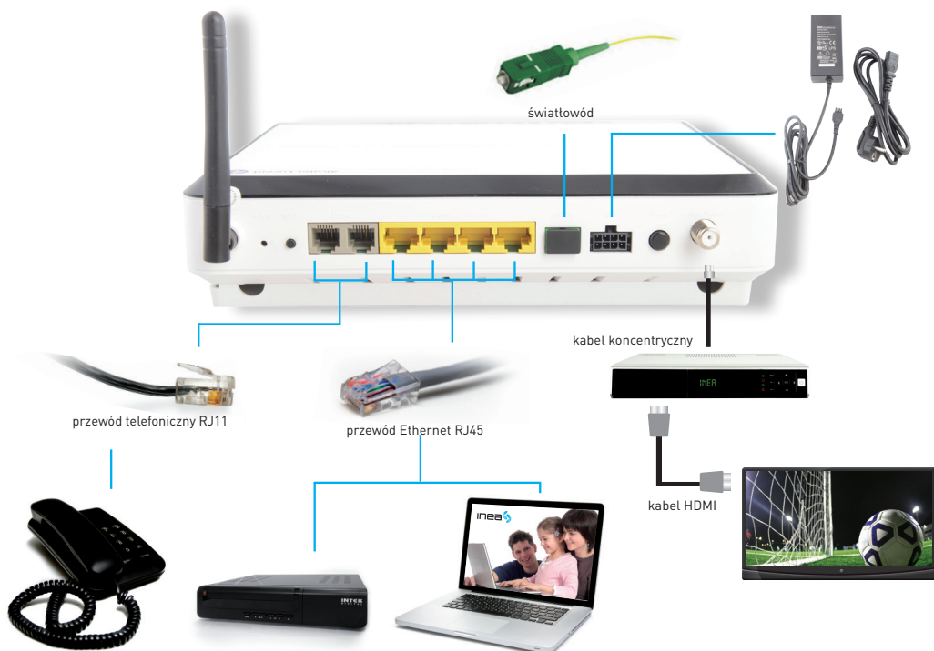
Rysunek 4 Schemat podłączenia modemu
